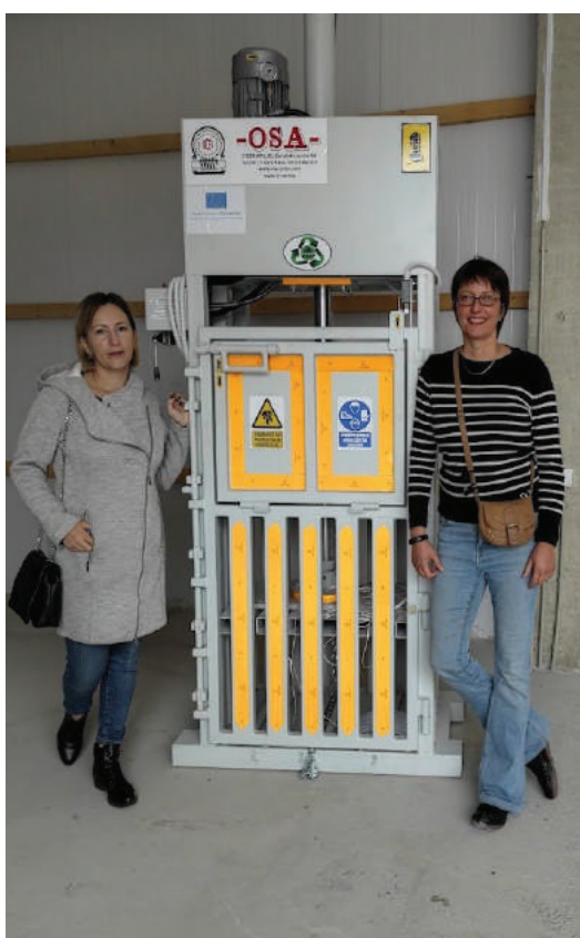
Tim Zero Waste Montenegro ispred hidrauličke prese (Sila pritiska: F=120kN (12 tona), ručne hidrauličke kontrole)
